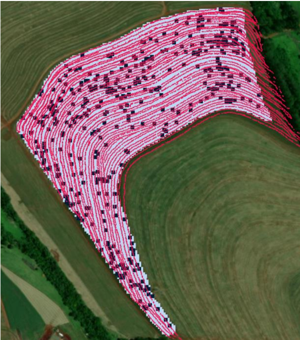
Figura 6. Mapa de duas zonas de manejo, fazendo uso de NDVI e sobreposição dos caminhos percorridos pela colhedora e pontos de coleta de dados de produtividade.
