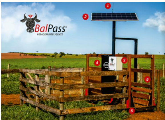
FIGURA 1. Balança de passagem BalPass, composta por antena para envio de dados via RFID (1), painel de energia fotovoltaico (2), central de processamento de dados (3), placa para leitura de dispositivos RFID (4), sensores infravermelhos (5) e barras de pesagem (6). Fonte: COIMMA (2022). BalPass pass-through scale, consisting of an antenna for sending data via RFID (1), photovoltaic energy panel (2), data processing center (3), card for reading RFID devices (4), infrared sensors (5) and weighing bars (6). Source: COIMMA (2022).
