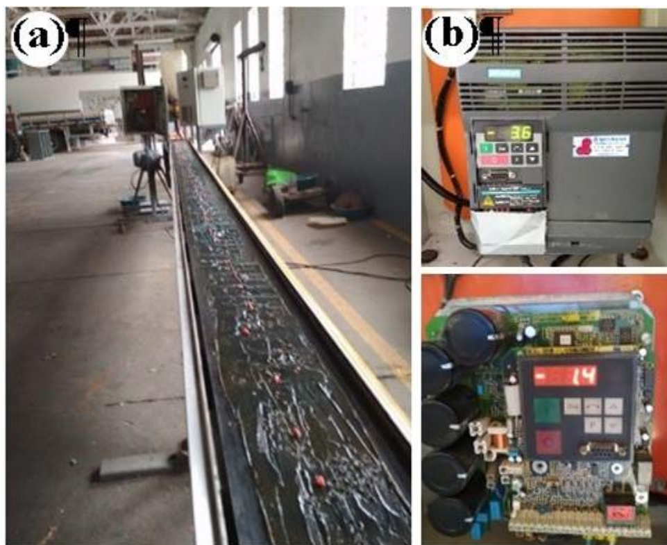
FIGURA 1. Equipamento utilizado para avaliação da qualidade de distribuição de sementes de milho. (a) esteira de borracha equipada com motor elétrico e inversor; (b) dois inversores de frequência, esteira (imagem superior) e semeadora (imagem inferior). Equipment used to assess the quality of maize seed distribution. (a) rubber mat equipped with electric motor and frequency inverter; (b) two frequency inverters, mat (upper image) and seeder (lower image).
