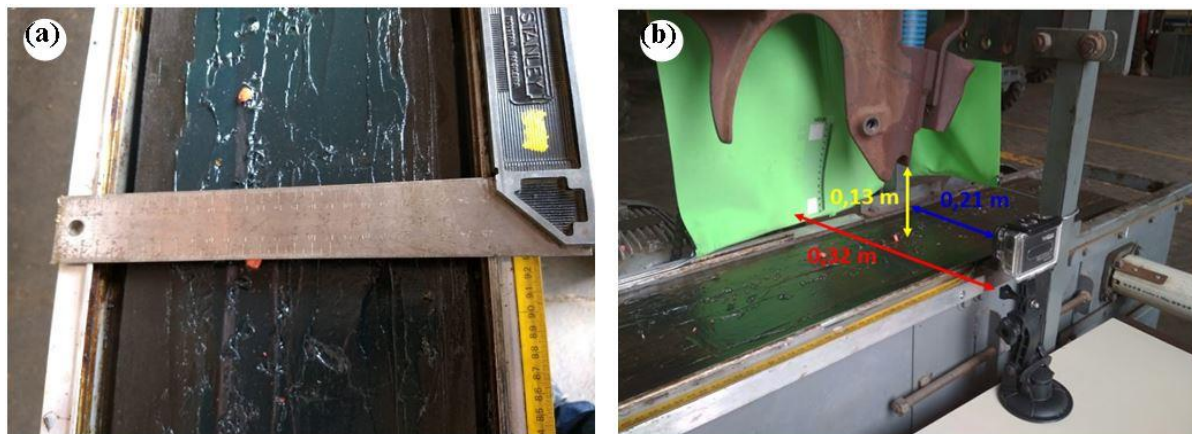
FIGURA 2. Métodos utilizado para mensuração das distâncias entre as sementes de milho. (a) aferição pelo uso de um esquadro metálico e fita métrica e (b) disposição do sensor óptico para posterior mensuração a partir de imagens. Applied methods to measure the distances between maize seeds. (a) measurement obtained from a metallic square and measuring tape and (b) optical sensor placement to further obtain distance measurements from images.
