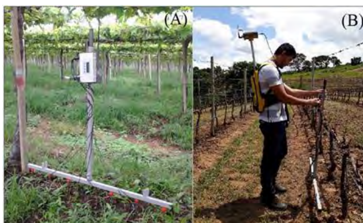
FIGURA 1. (A) Medidor portátil de condutividade elétrica aparente do solo (CEa) [Fonte: Nascimento, (2013)]; e (B) medida de CEa nas fileiras de plantas de videira de vinho durante o experimento, utilizando o medidor portátil acoplado ao receptor GPS ( rover ).
