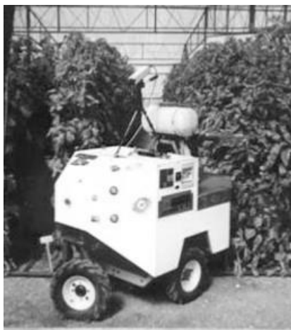
FIGURA 3. Robô móvel AURORA, dedicado ao serviço em estufas, particularmente em tarefas de fumigação. Desenvolvido na Universidade de Málaga (UMA) – extraído de (SECCHI, 2008).
