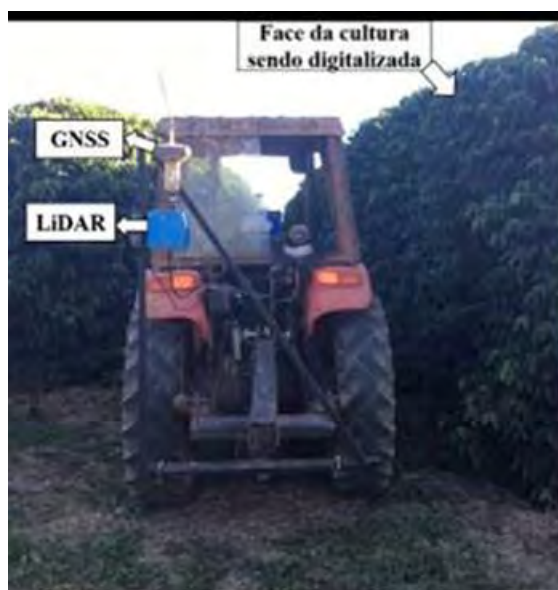
FIGURA 2. Estrutura e disposição dos equipamentos utilizados durante a coleta dos dados
