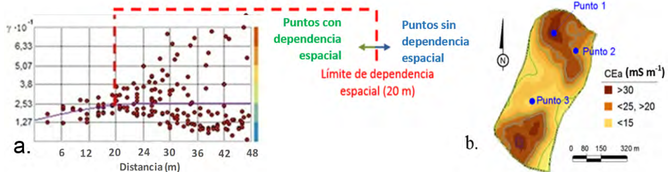
FIGURA 1. (a) Semivariograma generado con los datos obtenidos en el pre-muestreo; (b) mapa de CEa (mS/m) con localización de puntos de observación de suelo identificados. (a) Variogram of the pre-sampling data. (b) ECa map (mS m -1 ) with the locations of observation points identified.
