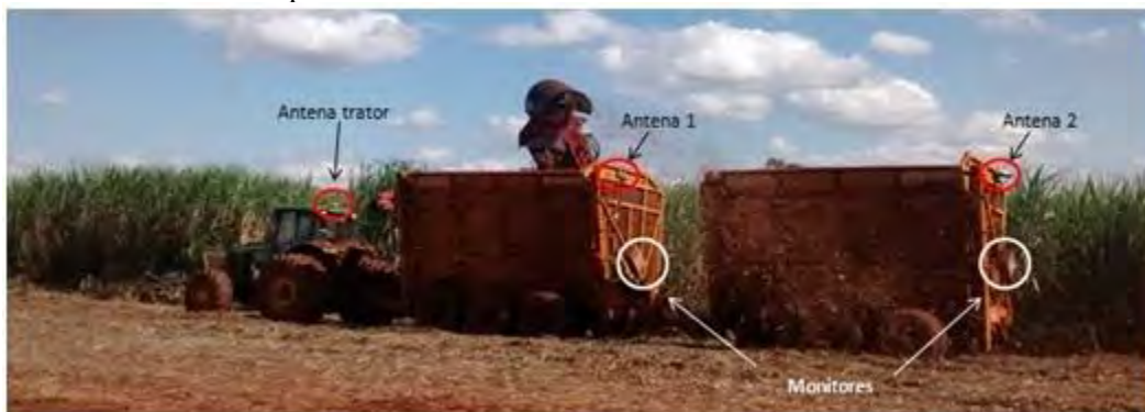
FIGURA 1. Representação do esquema da disposição das antenas de GNSS no conjunto. Schematic representation of the arrangement of GNSS antennas in the set.
