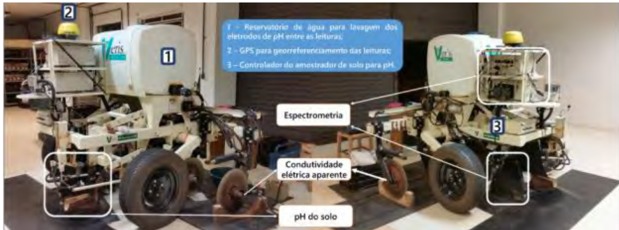
FIGURA 1. Plataforma multisensores de solo para aquisição de dados de condutividade elétrica, pH e espectroscopia de reflectância (Vis-NIR) do solo. Soil multisensor platform to collect data of electrical conductivity, soil pH and spectral reflectance (Vis-NIR).
