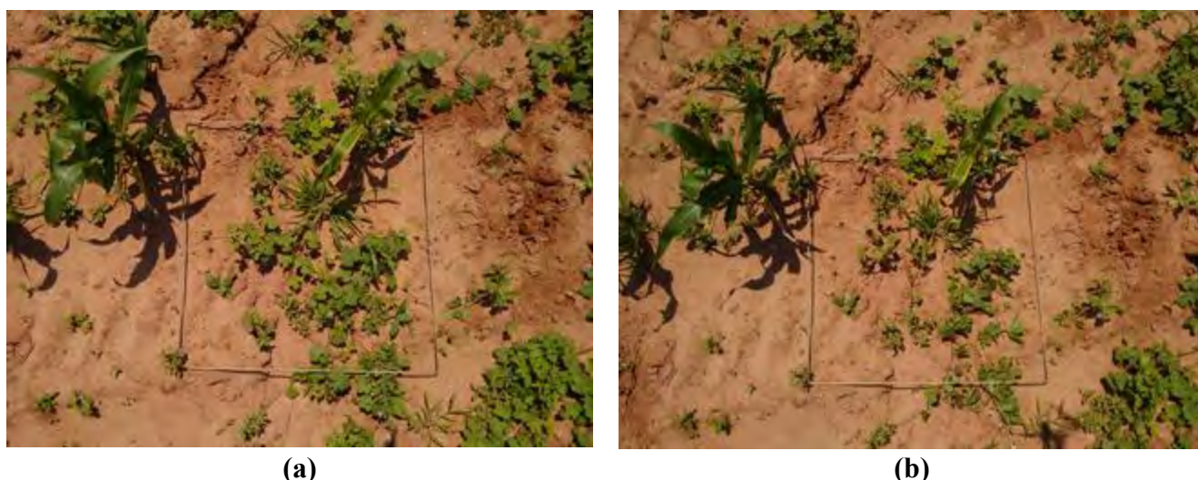
FIGURA 2. Imagem pontual a dois metros de altura (a) sem deslocamento de ar e (b) com deslocamento de ar gerado por um VANT em funcionamento. Spot image to two meters high (a) without UAV and (b) with UAV in operation.
