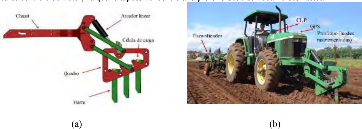
FIGURA 1. Hastes instrumentadas e quadro articulado do protótipo (a). Protótipo do sistema de controle de profundidade variável, composto do sistema de leitura de força de cisalhamento do solo, GPS, CLP e escarificador(b). Instrumented blades and articulated chassis prototype (a) Prototype control system of variable depth, consisting of the reading of shear strength of soil, GPS, PLC and chisel plow (b).
